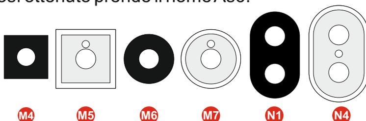
16) Verificare i fori dei pezzi M4 M5 o n°M6 M7 o N1 N4 affinché possano inserirsi comodamente sul parasole della fusione A1 o A2 eventualmente rifinire i fori con una piccola lima tonda. Verniciare la parte posteriore con del fondo grigio (Art. 22-106) oppure un altro prodotto con tonalità codifica RAL7001, le parti anteriori dei pezzi M4 M6 o N1 con del nero opaco (Art. 22-106) e il bordo dei pezzi M5 M7 o N4 con del bianco opaco (Art. 22-108)
