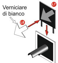
21) La decals a strisce nere va usata solo nel montaggio di un segnale di avviso. La base della decals e di tipo continuo tagliare seguendo gli indicatori di taglio con una forbice affilata o un cutter lasciando solo unpiccolo bordo trasparente intorno. Nel caso di realizzazione di questo tipo di segnale si dovrà tagliare con una forbice il pezzo L4 lungo la linea tratteggiata visibile nella figura 20.
