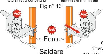
15)Inserire i gruppi As2 al gruppo As5 nei fori indicati in figura 13 saldandoli nella parte inferiore della mensola As3 Inserire i fili nel palo ponendo molta attenzione a non graffiare la superfice isolante dei fili. Per precauzione nei punti critici si può passare della vernice come ulteriore isolamento. Provare nuovamente i led prima del fissaggio definitivo. Per i semafori a vela quadrata il sistema mensole
